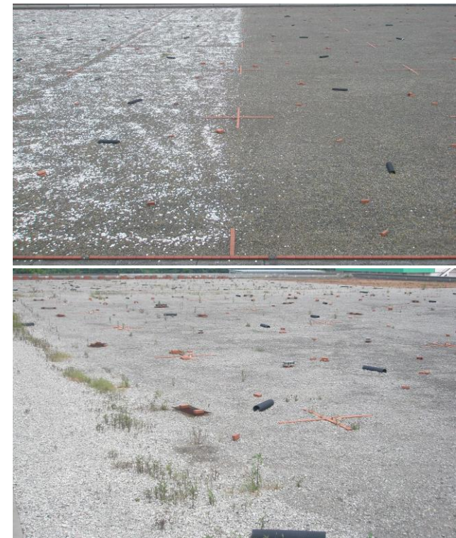
貝殻区と対照区の比較（上）と破砕コンクリート部の様子（下）
